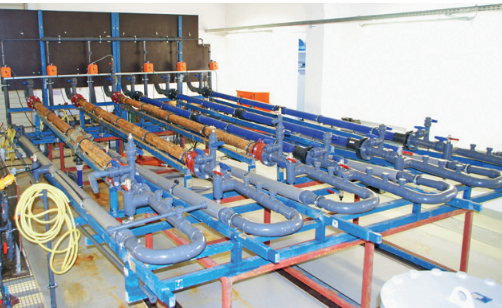
Abb. 1: Versuchsanlage in der Dimension DN 80 zur Untersuchung der Effekte von Korrosionsinhibitoren
