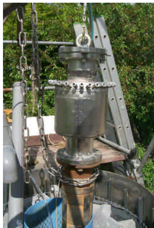
Abb. 4-1: Realaufnahme des Spülkopfes NDSK 300 a) Testgerät b) Einbau der Spülkopf/Pumpe-Kombination bei den Vortests
