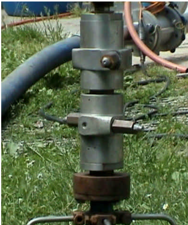
Abb. 4-4: Doppelrotationsaggregat des JET Master von E+M a) Detailaufnahme der Düsen b) Demonstration der Wassernebelbildung (außerhalb des Brunnens)
