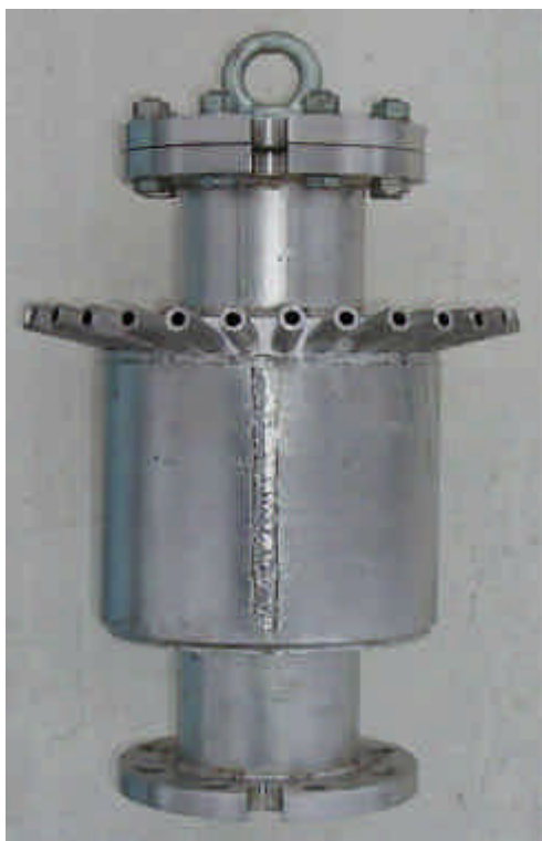
Abb. 4-1: Realaufnahme des Spülkopfes NDSK 300 a) Testgerät b) Einbau der Spülkopf/Pumpe-Kombination bei den Vortests
