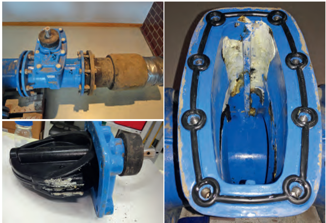
Abb. 2: Störende Biofilme durch nicht sachgemäße Handhabung von Schmierstoffen
