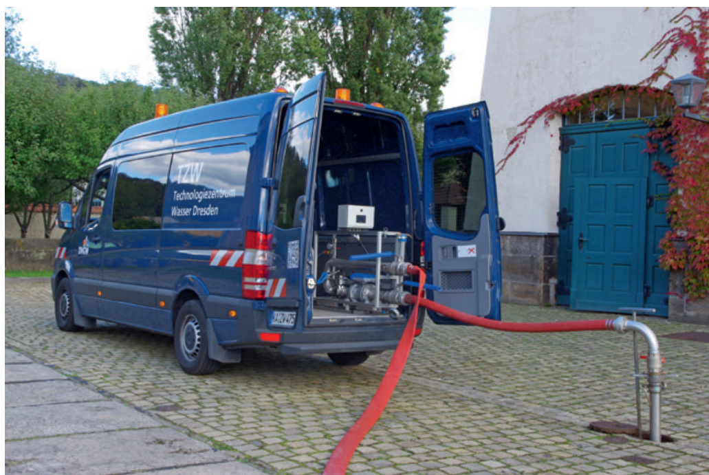
Abb. 5: Untersuchungsfahrzeug mit Spülplan FlushInspect zur Erfassung von Trübung und Durchfluss bei der Spülung
