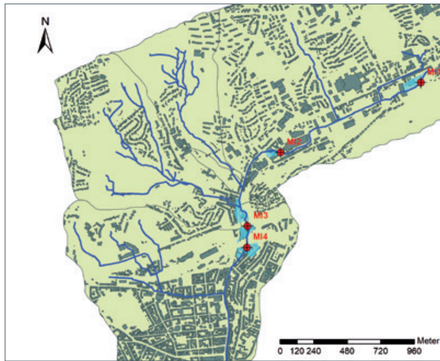
Abb. 2: Exemplarischer GIS-Datenauszug für einzelne Hotspots, Überflutungsflächen eines 500-jährlichen Hochwassers und betroffener Gebäude
