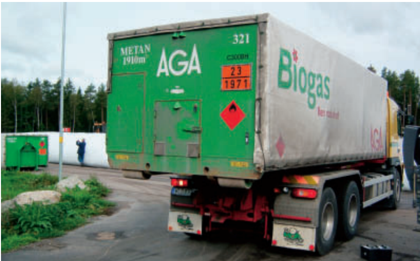
Abb. 9: Straßentransport von Biomethan in Schweden mit einem „Swap-body-system“
