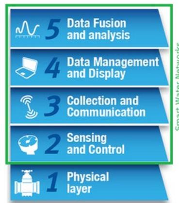
Abbildung 1: Ebenen von Wasser 4.0 bzw. eines Smart Water Network (Chan 2014).
