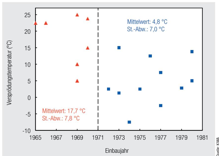
Abb. 1: Einfluss des Einbaujahres auf die Versprödungstemperatur
