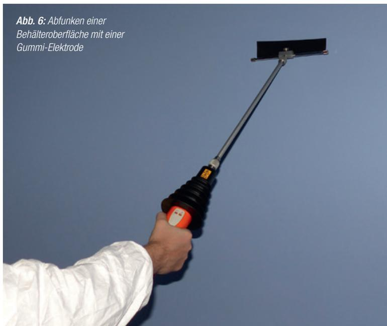
Abb. 6: Abfunken einer Behälteroberfläche mit einer Gummi-Elektrode
