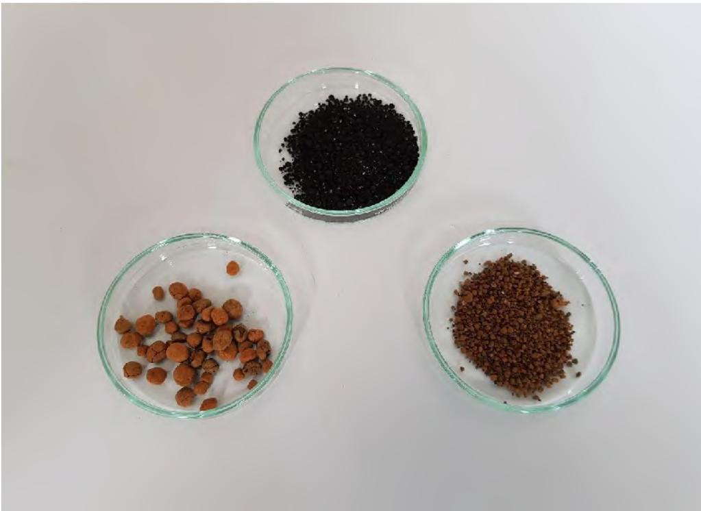
**Abbildung 28: Beispiele Filtersand**
