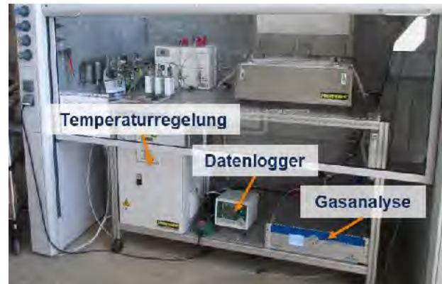
Abbildung 5: Versuchsstand Gesamtansicht
