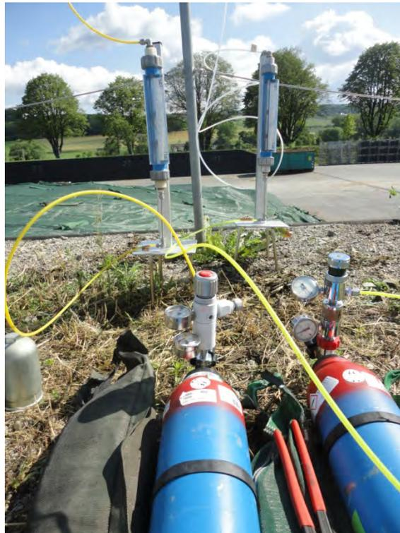
Abb. 7.4: Druckgasflaschen, Druckminderer und Schwebekörperdurchflussmesser zur zusätzlichen Methanfreisetzung.
