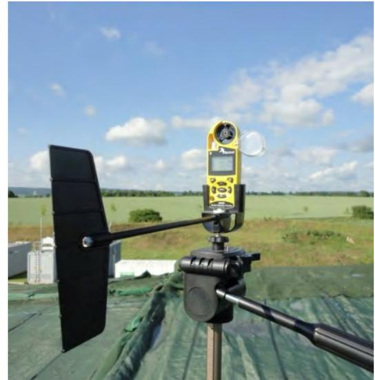
Abb. 7.6: Windmessgerät mit Fahne u. Halterung im Betrieb
