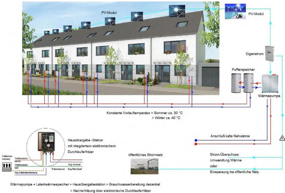
**Abbildung 0-25: Anschluss an ein kaltes Nahwärmenetz mit zentraler Elektrowärmepumpe, Pufferspeicher und PV [91]**
