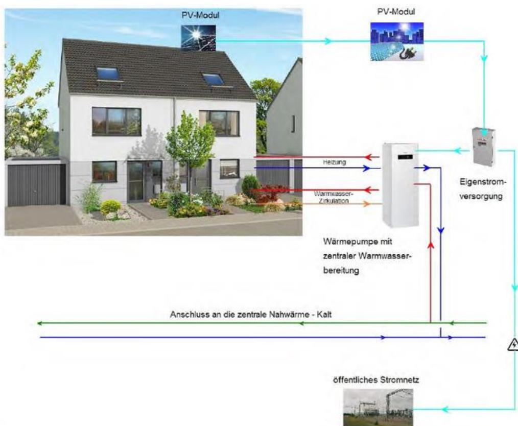
Abbildung 0-24: Anschluss an ein kaltes Nahwärmenetz mit dezentraler Elektrowärmepumpe und PV [91]
