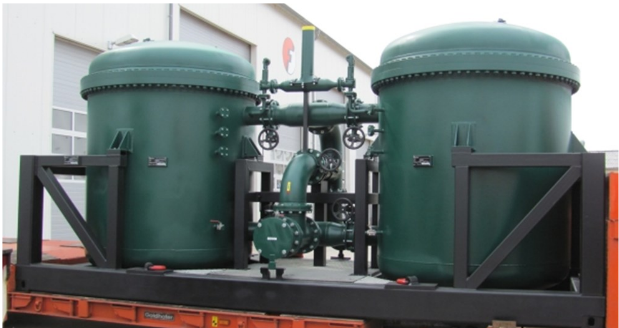
Abbildung 14: Beispiel Fa. Fangmann Industrie – Abscheiderskid mit 2 Adsorbern (DN 250; DP64)
