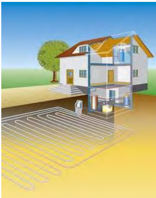
Abbildung 6-3: Wärmepumpe mit Erd-Flachkollektoren [HeVi12a]
