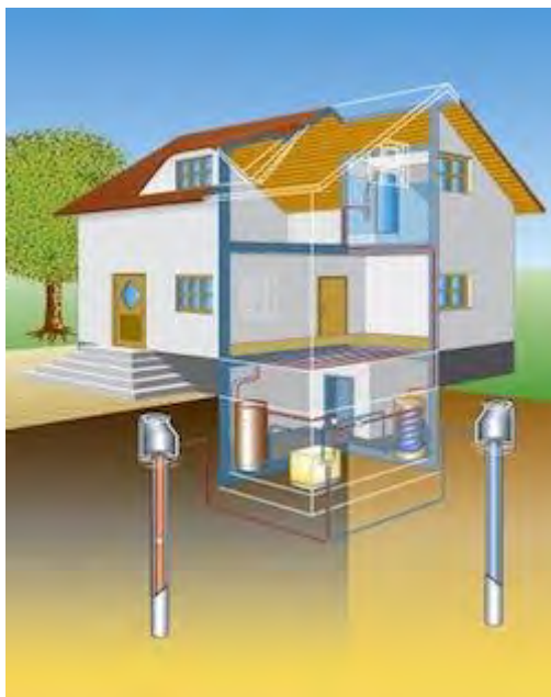
Abbildung 6-1: Wärmepumpe mit Grundwassernutzung [HeVi12]
