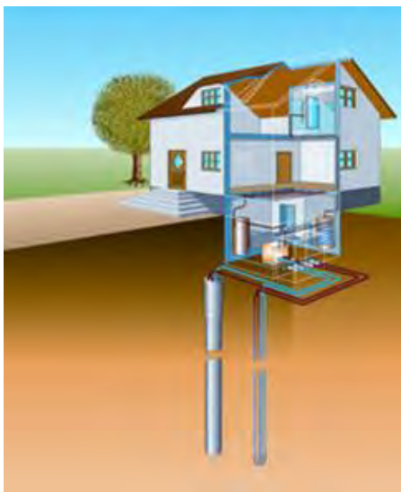
Abbildung 6-25: Modell einer Wärmepumpenheizung mit Erdwärmesonde [BWP]
