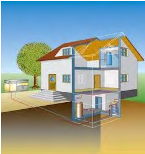
Abbildung 6-29: Wärmepumpe mit Luftkollektor [HeVi12c]
