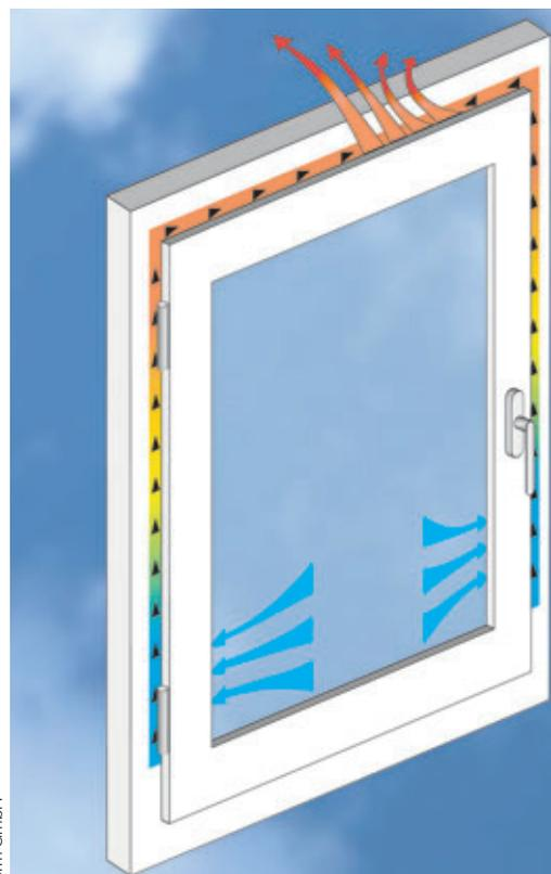
Abb. 3: Strömung der Luft seitlich von außen ins Fenster und nach oben in den Raum
