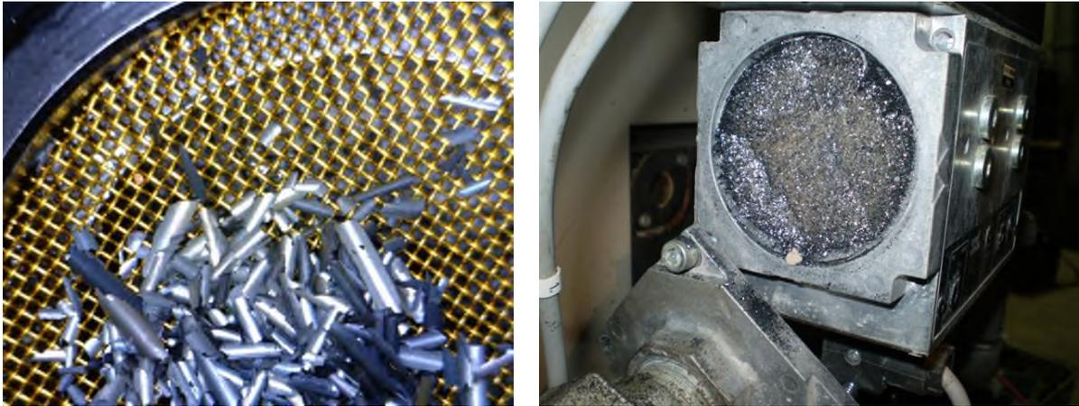
Abbildung 1: Partikel im Sieb eines Zählerdruckregelgerätes (links); Partikel im Filter einer Gasdruck-Regelarmatur (rechts)
