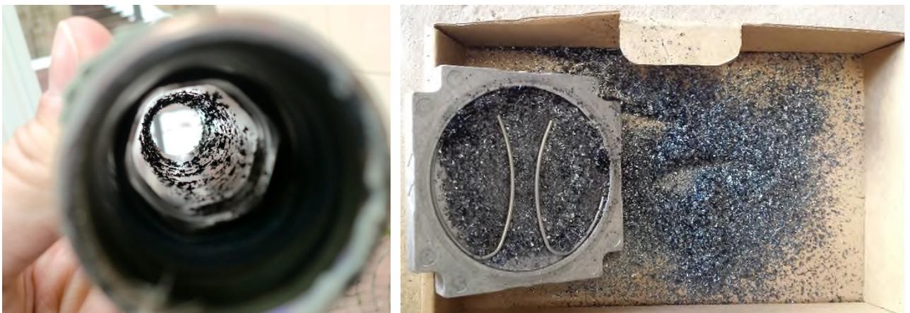
Abbildung 1: Innenansicht Kupferleitung mit Ablösung der Sulfidschicht (links); Partikel aus dem Filter einer Gasdruck-Regelarmatur (rechts)
