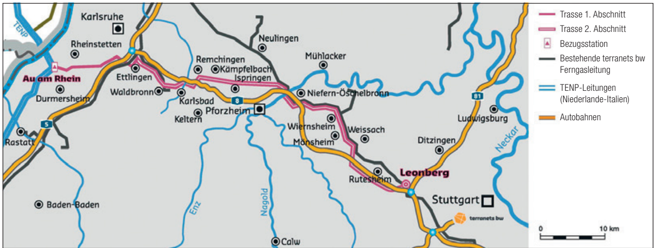
Abb. 2: Die rund 71 km lange Nordschwarzwaldleitung verbindet die Region Stuttgart mit der Trans-Europa-Naturgas-Pipeline (TENP).
