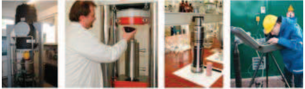
Bild 2. Analyse und Forschung am DBI (v.l.n.r.: Permeationsversuchsanlage für Rohrleitungsmaterial, Hochdruckprüfstand für Gesteinsparameter, Taupunktmessung).
