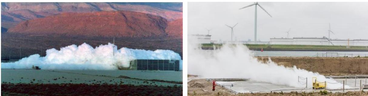
Abbildung 9-2: Sichtbarer Nebel durch Wasserdampfkondensation im Bereich der freigesetzten Flüssigphase von LNG. Links: Freisetzung großer Mengen flüssigen LNGs, rechts Freisetzung einer kleineren Menge von rund 150 kg in einem Testaufbau [15]
