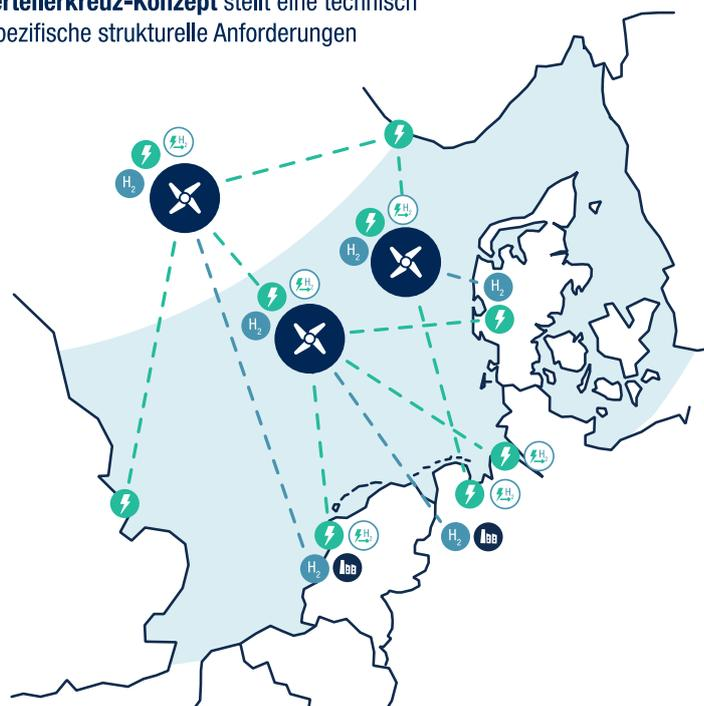
Abbildung 5: Umwidmung von Erdgas-Förderplattformen zu Power-to-Gas-Hubs in der Nordsee und Nutzung bestehender Infrastrukturen
