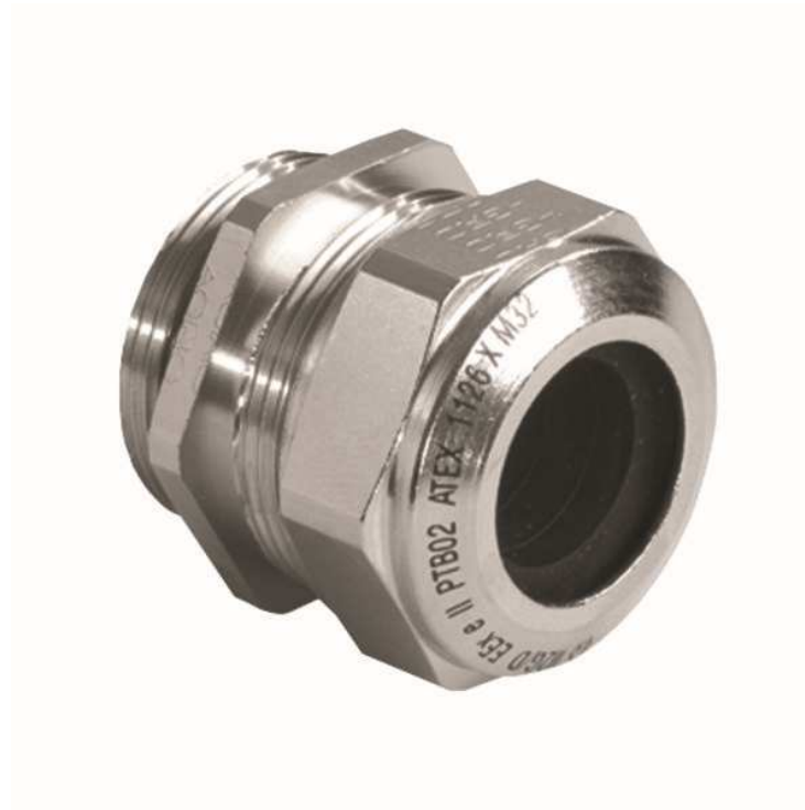
AGRO Kabelverschr. PROGRESS MS M20 kurz Ex e II Kabel Ø 8 - 11 mm e steht für Zündschutzart erhöhte Sicherheit II Gerätegruppe 2 (Übertage)
