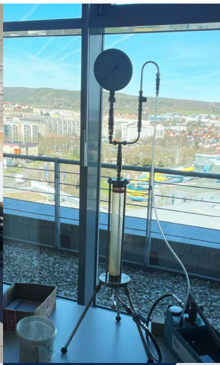
Verdeutlichung an einem Model: Problematik Druckaufbau- Mindestdruckabfall mit und ohne Lufteinschlüsse
