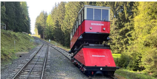
Das Herzstück des Bergbahnlandes ist die Standseilbahn, diese wurde ursprünglich zum Transport von Güterwagen vom Tal auf die Hochebene gebaut
