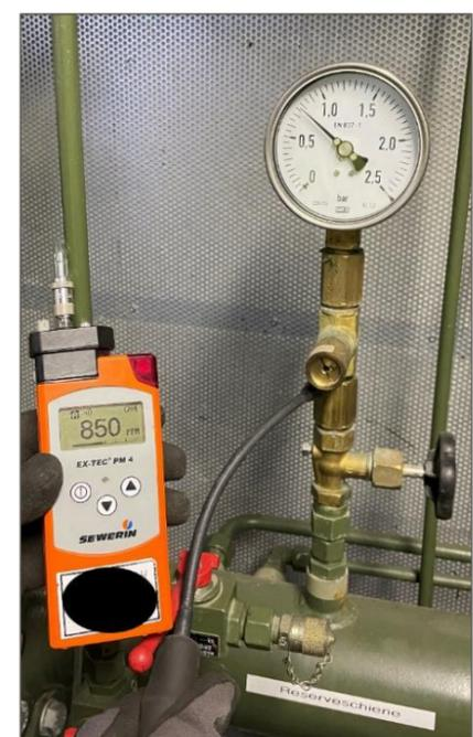
Was fehlte in diesem Fall? → Kein Vorgang/Auftrag für erneute Leckdetektion...spätestens 45 T. nach Reparatur
