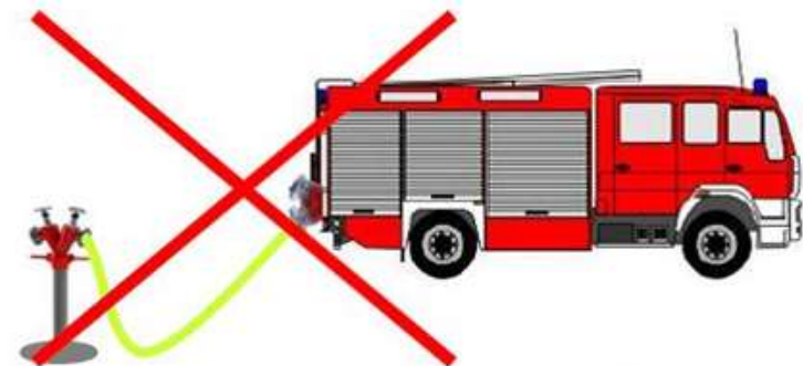
Wasserentnahme aus Trinkwassernetz
