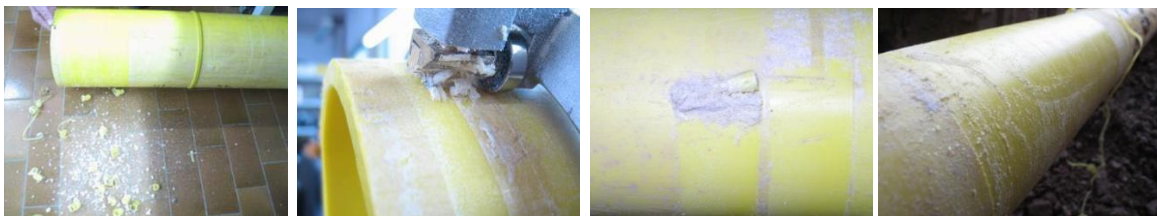
Bild 1, 2, 3 und 4: Gasrohre aus gelbem PE 80 mit stark ausgeprägter Materialanomalie
