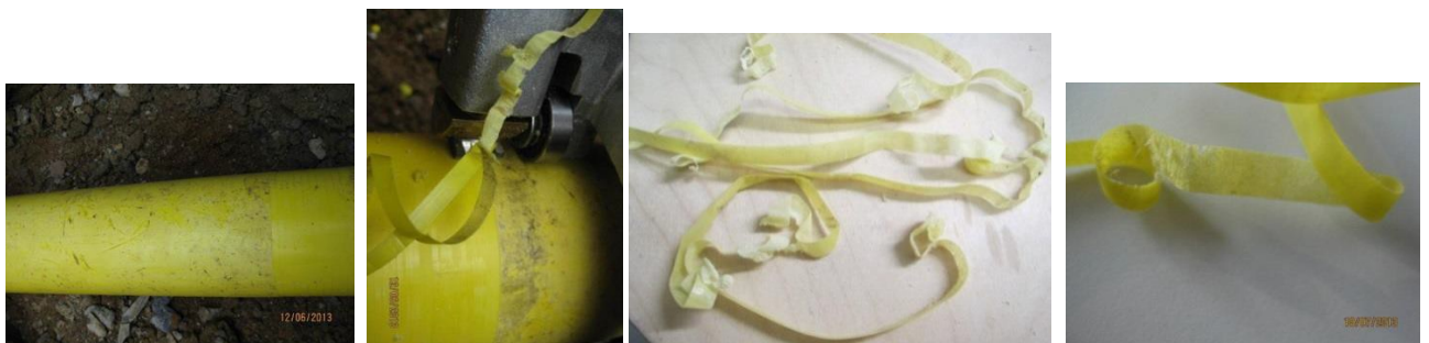
Bild 7, 8, 9 und 10: Gasrohr aus gelbem PE 80 mit leicht ausgeprägter Materialanomalie
