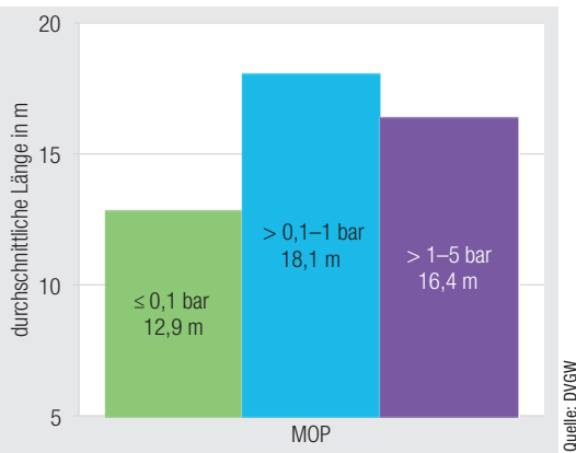
Abb. 2: Hausanschlüsse nach MOP/durchschnittliche Länge in Metern
