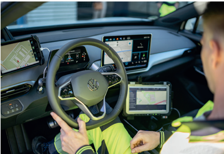
Abb. 4: Auf den Displays im Innern des Pkw sieht der Fahrer unterwegs auf einen Blick alle wichtigen Messwerte im betreffenden Streckenabschnitt.
