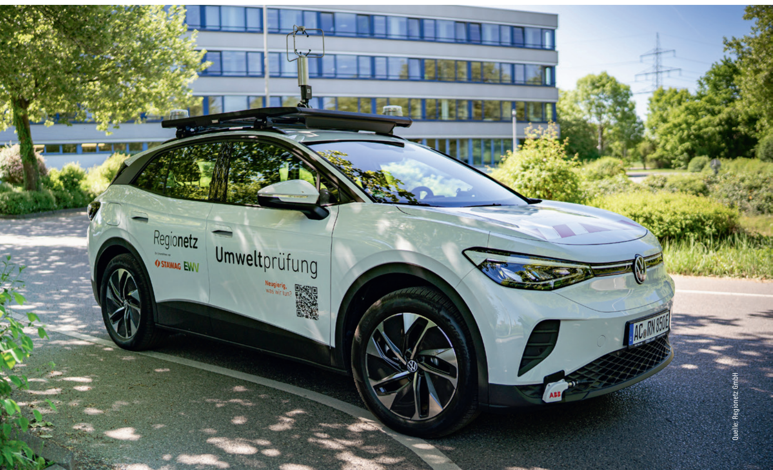
Abb. 1: Das fahrzeugmontierte System MobileGuard eröffnet neue Perspektiven für eine zuverlässige und effiziente Gasdetektion mit dem Fahrzeug
