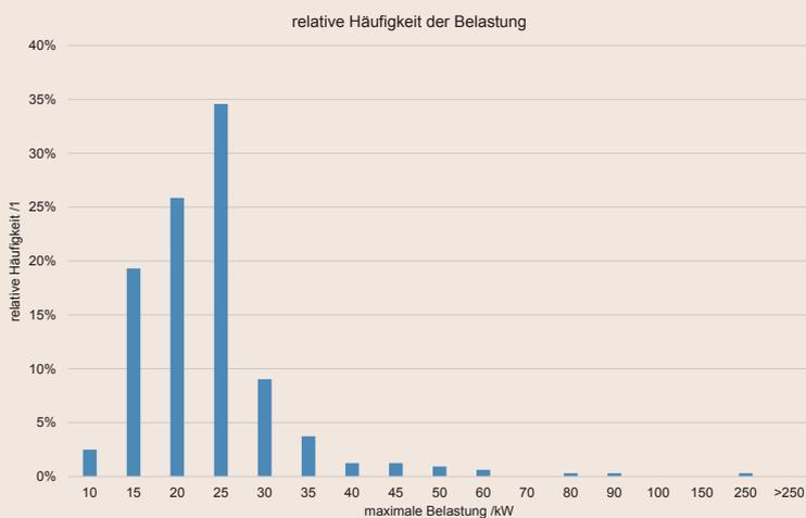
**Bild 6:** Verteilung der Belastungen der Gasgeräte
