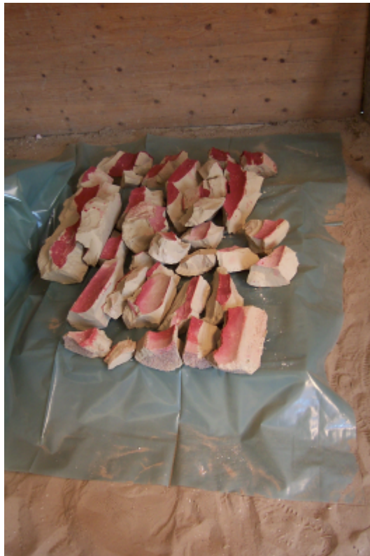
Bild 3: Einfärbungen der inneren Kontaktfläche auf der ganzen Länge (Versuch Nr. 8, aufgrund der hohen Druckfestigkeit wurden die Abdichtungsmassen beim Ausbau aus den Behältern weitgehend zerstört)
