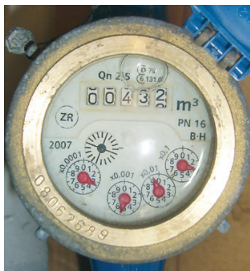
Abb. 2: Kaltwasserzähler Zenner MNK Q_n 2,5 m 3 /h, Kl. B-H mit Eichung 2008
