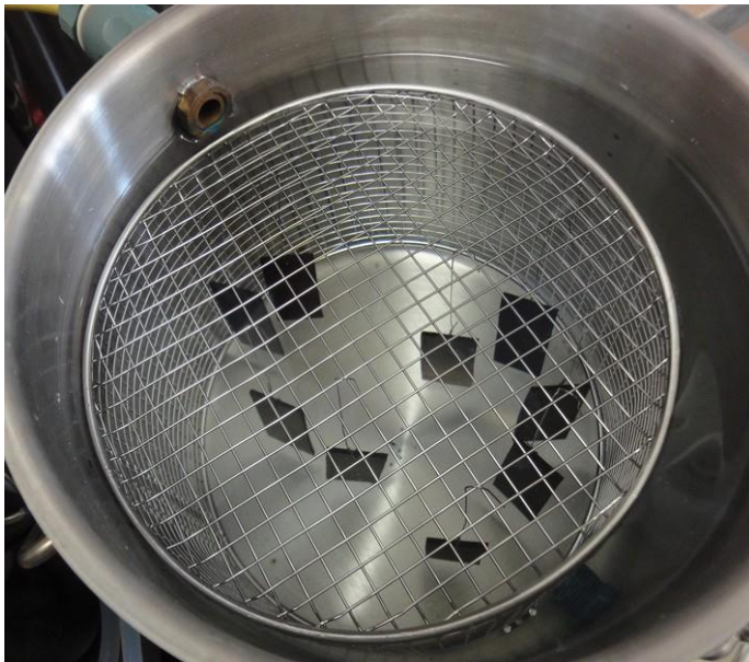
Abbildung 3-7: Durchflussbehälter mit Materialträgern
